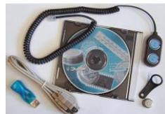
DS1923-F5 необходимо подключать к ПК при помощи USB адаптера из комплекта обслуживания iBDLR-0-U только для задания ему начальных пользовательских установок регистрации (дату и время старта, интервал измерений и т.п.) и для чтения с него данных после цикла регистрации. В остальное время он работает автономно. Каждый прибор DS1923-F5 имеет свой идентификационный уникальный номер и блокнотную память для ввода служебной информации.
